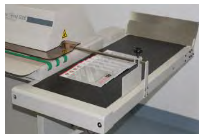
Volitelný vykládací dopravník šířky 500 mm s kapacitou do 100 ks vazeb průměr 1/4" (6,9 mm).
