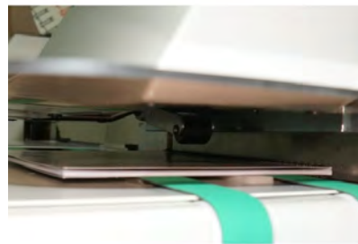
Zavírací jednotka s funkcí automatického vystředění.
